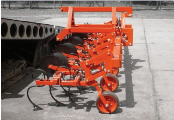
Heckhackgerät mit Wechselrahmen, Frontaufbau
