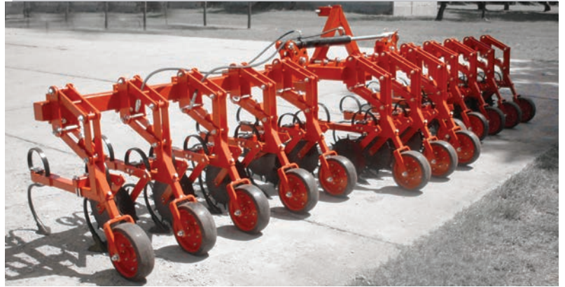
Hackgerät 12-reihig, 45-50 cm, Frontanbau
